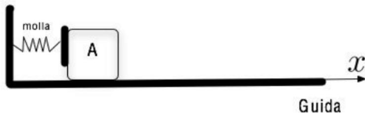
Apparato sperimentale: una guida, una molla e il corpo di prova. La molla è fissata al supporto ed il suo estremo libero è stato accostato al corpo A. Il riferimento cartesiano è costituito dall'asse delle  $x$  con origine il punto 0.
